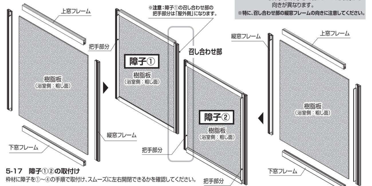
**注意** ●各フレームはギザギザ部分を樹脂板へはさみ込むようにしてください。
