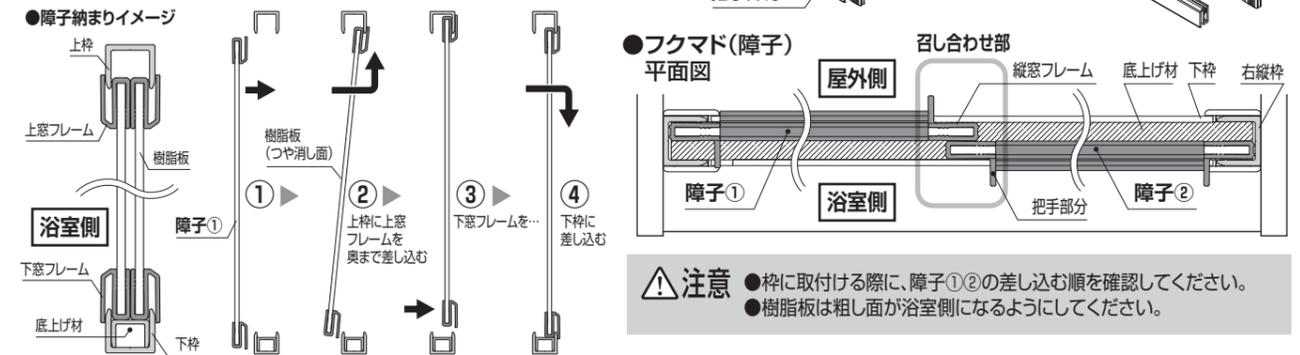
**注意** ●枠に取付ける際に、障子①②の差し込み順を確認してください。
